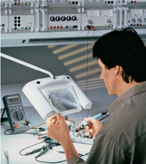
Bild 31: Eine gute Beleuchtung und die Vergrößerung des Arbeitsgegenstands sind für diese Arbeit unerlässlich.
