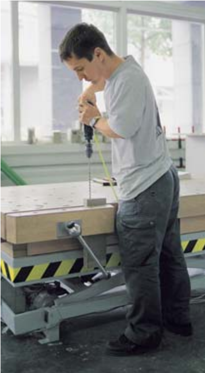
Bild 14, 15 und 16: Bei dieser Hobelbank kann je nach Arbeitsaufgabe eine andere Arbeitshöhe eingestellt werden.
