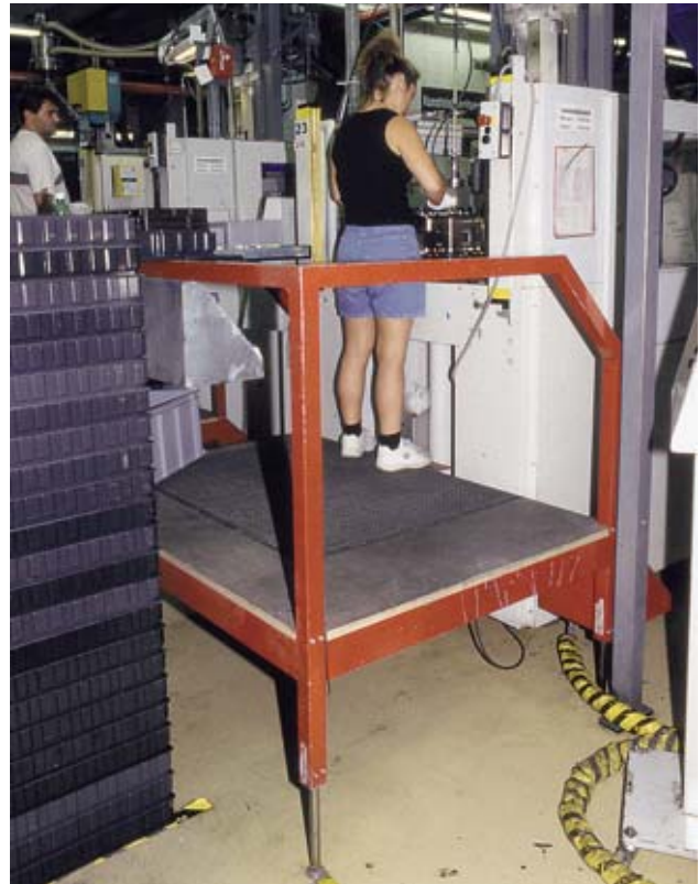
Bild 2: Mit solch höhenverstellbaren Podesten konnte sowohl die Ergonomie verbessert als auch die Produktivität um 10 % gesteigert werden.
